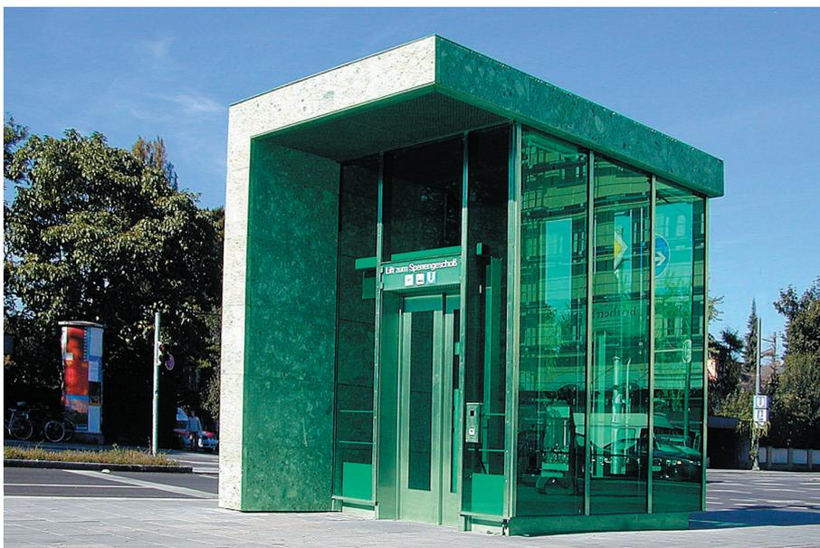
Mit dem Neubau von zwei Lifтанlagen aus Glas wird Licht vom Strassenniveau in das Sperrengeschoss geholt und eine direkte Sichtbeziehung zum U-Bahnsteig geschaffen. Durch den Umbau und die Sanierung des Sperrengeschosses mit Glasabtrennungen, Abruch von Technikräumen, Erneuerung von Bodenbelägen, Deckenverkleidung und Beleuchtung entsteht ein klares, helles und transparentes Zwischengeschoss, in dem man sich einfach orientieren kann und sich gerne aufhält.
